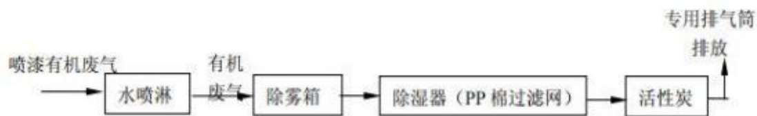
图2.6-2 有机废气处理设施工艺流程图
