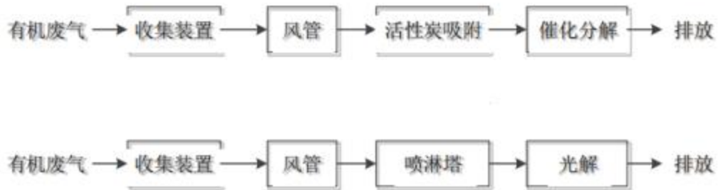
图3.3-9 金属框眼镜电泳和喷漆有机废气处理工艺流程图
